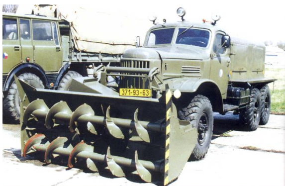
Sněhová fréza D-470 na podvozku automobilu ZIL-157 měla šířku záběru 2,52 m a výkon 625 t sněhu za hodinu.
