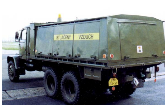
Mobilní přepravník stlačeného vzduchu Praga V3S VPS s 30 kusy tlakových lahví s provozním tlakem 15 MPa.
