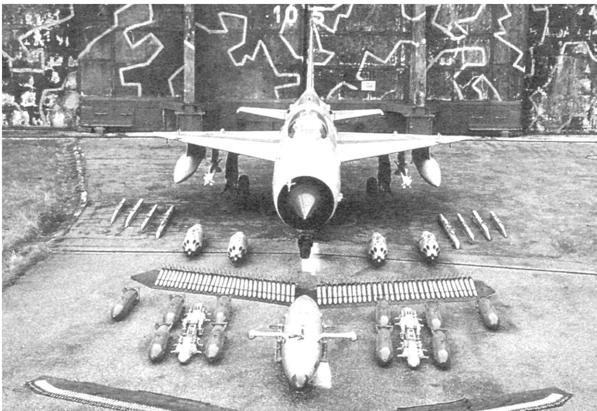
Víceúčelový „dvou machový“ MiG-21MF s ukázkou výzbroje.
