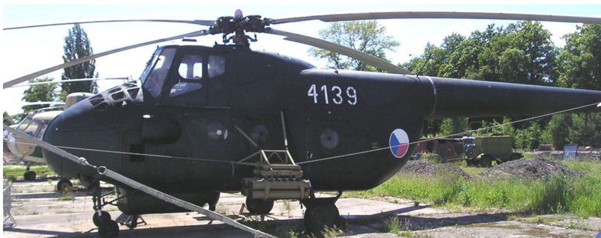
Vrtulník Mil Mi-4B mohl nést čtyři raketomety RM-130/4 se čtyřmi JRRO-130 ráže 130 mm nebo čtyři raketomety UB-16-57UMVP se 16 neřízenými raketami ráže 57 mm.
