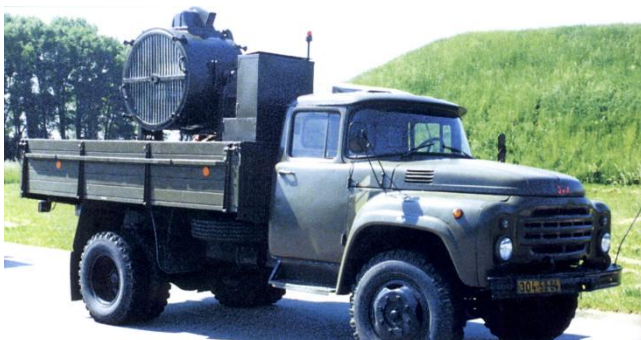
Mobilní světlo ZIL-130 APM-90M měl průměr 0,9 m mohl na svícení použít žárovku 110V a 90 A nebo obloukovou lampu 80 V a 150 A.
