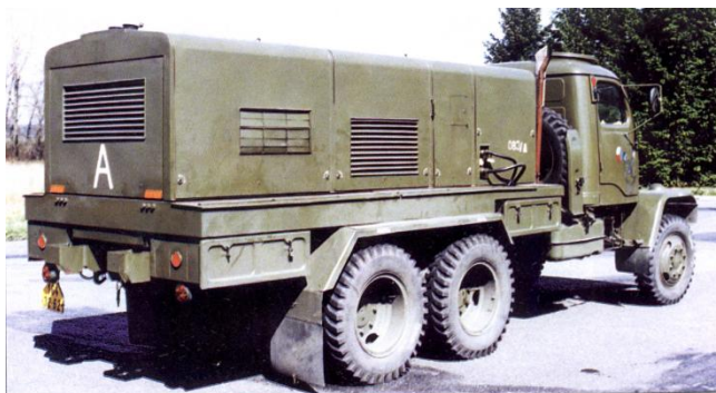
Mobilní energetický zdroj Praga V3S SUEZ M s centrálou o výkonu 60 kW a měniči. Mohl dodávat stejnosměrné napětí 24/28 V s proudem 1 500 až 2 000 A, střídavé napětí 115 V, 3 x 36 V a 3 x 208 V.
