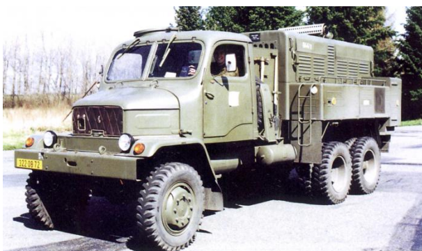
Mobilní hydraulický zdroj Praga V3S UPG-250 GM s max. pracovním tlakem 25 MPa a průtokem 43 l/min.
