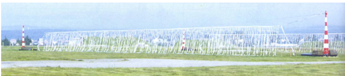
Záchytné zařízení TFF-82 Rool-Stop (na snímku zdvojené) pro zachycení letounů se závadou na brzdovém systému, nahoře v klidové a dole v pohotovostní poloze. Doba vztýčení byla do 1 s. Do činnosti se uvádělo ručně nebo pracovalo v automatickém režimu.
