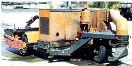
Prostředek MADRO na úklid letištní plochy pomocí rotujících kartáčů a ofoukávání vzduchem.
