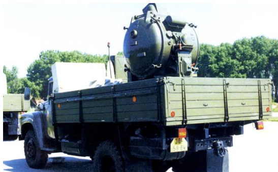
Mobilní světlo ZIL-130 APM-90M měl průměr 0,9 m mohl na svícení použít žárovku 110V a 90 A nebo obloukovou lampu 80 V a 150 A.
