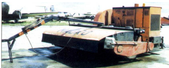
Prostředek MADRO na úklid letištní plochy pomocí rotujících kartáčů a ofoukávání vzduchem.
