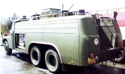
Hasičí cisternový automobil Tatra T-148 CAS 32 se zásobou 6 000 l vody a 400 l pěnidla.
