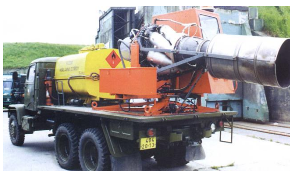
Mobilní odmrazovací zařízení na vozidle Praga V3S OZ-88 tvořil proudový motor M701, nádrž byla na 2 000 l paliva, což vystačilo na tři hodiny provozu. Celá nástavba byla otočná.
