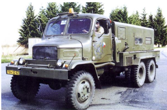
Mobilní energetický zdroj Praga V3S SUEZ M s centrálou o výkonu 60 kW a měniči. Mohl dodávat stejnosměrné napětí 24/28 V s proudem 1 500 až 2 000 A, střídavé napětí 115 V, 3 x 36 V a 3 x 208 V.
