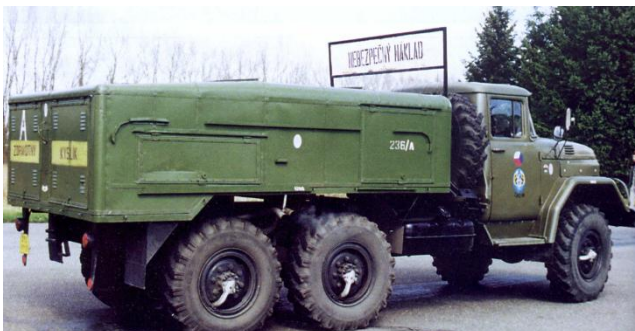
Mobilní přepravník lékařského kyslíku ZIL-131 AKZS-75MP s 21 kusem tlakových lahví s max. tlakem 15 MPa.
