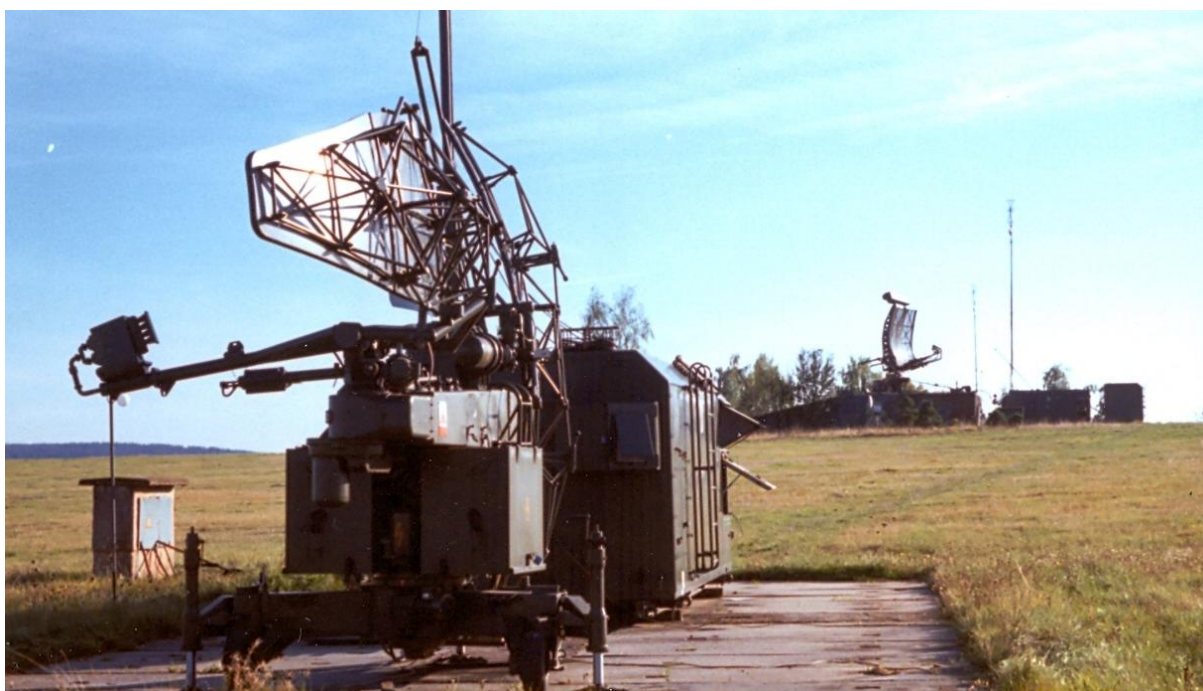
Radiolokátory přistávacího systému RPL-5A, vpředu anténní jednotka přesného přistávacího radiolokátoru PR-5A, vzadu anténní jednotka přehledového letištního radiolokátoru RL-5A s anténou sekundárního radiolokátoru.
