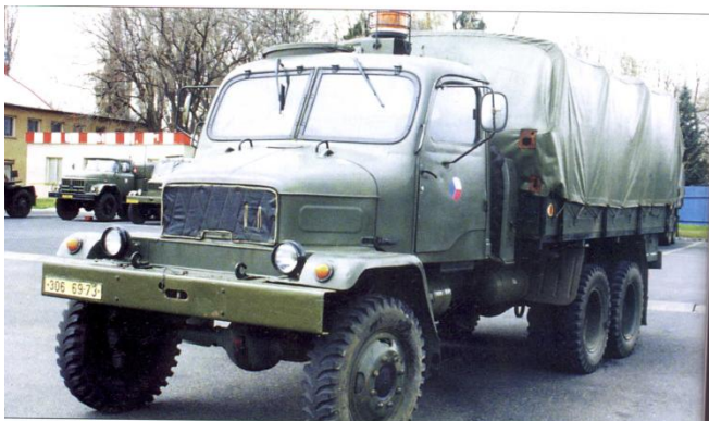
Mobilní zateplovací prostředek Praga V3S TO5. Horký vzduch měl teplotu max. 150 °C.
