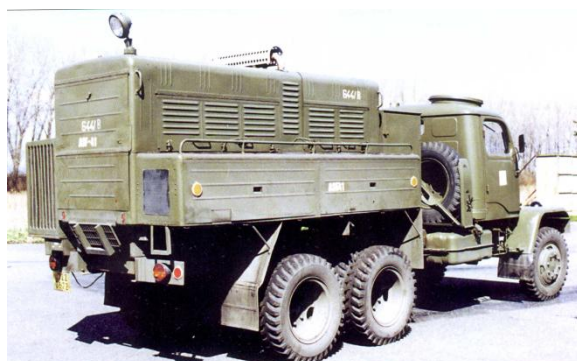
Mobilní hydraulický zdroj Praga V3S UPG-250 GM s max. pracovním tlakem 25 MPa a průtokem 43 l/min.
