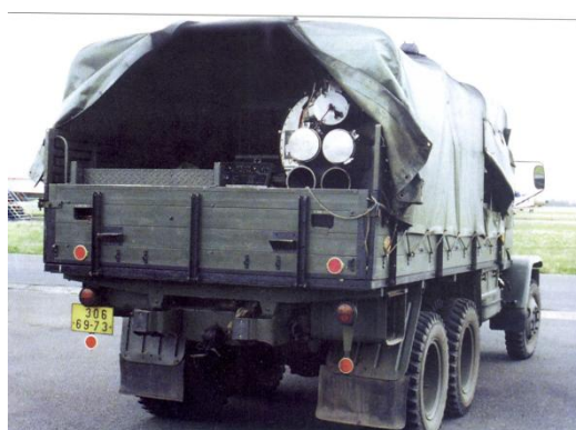
Mobilní zateplovací prostředek Praga V3S TO5. Horký vzduch měl teplotu max. 150 °C.
