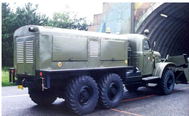
Sněhová fréza D-470 na podvozku automobilu ZIL-157 měla šířku záběru 2,52 m a výkon 625 t sněhu za hodinu.
