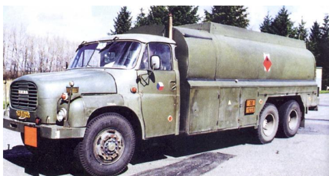
Automobilová cisterna Tatra T-148 CAPL 15 (objem 15 m 3 ) s cisternovým přívěsem (objem 10 m 3 ) na přepravu pohonných hmot. Automobil byl vybaven hadicemi s plnicími koncovkami pro gravitační plnění letounů.
