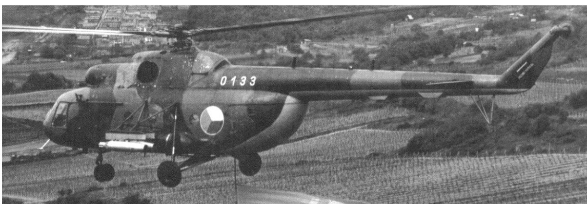
Vrtulník Mil Mi-8T se čtyřmi raketomety UB-16-57UMVP se 16 neřízenými raketami ráže 57 mm.
