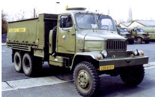
Mobilní přepravník stlačeného vzduchu Praga V3S VPS s 30 kusy tlakových lahví s provozním tlakem 15 MPa.
