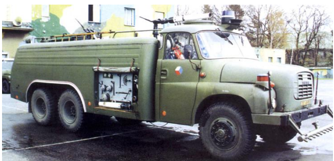
Hasičí cisternový automobil Tatra T-148 CAS 32 se zásobou 6 000 l vody a 400 l pěnidla.
