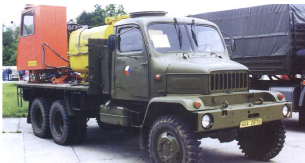
Mobilní odmrazovací zařízení na vozidle Praga V3S OZ-88 tvořil proudový motor M701, nádrž byla na 2 000 l paliva, což vystačilo na tři hodiny provozu. Celá nástavba byla otočná.
