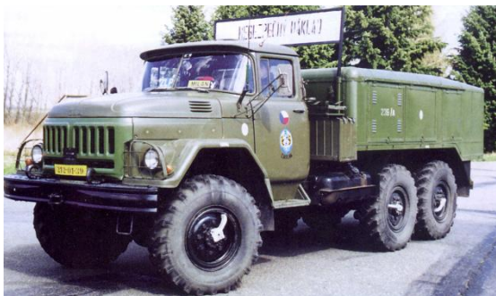
Mobilní přepravník lékařského kyslíku ZIL-131 AKZS-75MP s 21 kusem tlakových lahví s max. tlakem 15 MPa.
