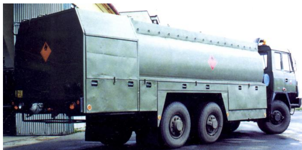
Automobilová cisterna Tatra T-815 CAPL 18 (objem 18 m 3 ) s možností tlakového i gravitačního plnění letounů.
