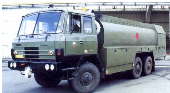
Automobilová cisterna Tatra T-815 CAPL 18 (objem 18 m 3 ) s možností tlakového i gravitačního plnění letounů.
