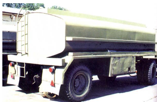
Automobilová cisterna Tatra T-148 CAPL 15 (objem 15 m 3 ) s cisternovým přívěsem (objem 10 m 3 ) na přepravu pohonných hmot. Automobil byl vybaven hadicemi s plnicími koncovkami pro gravitační plnění letounů.
